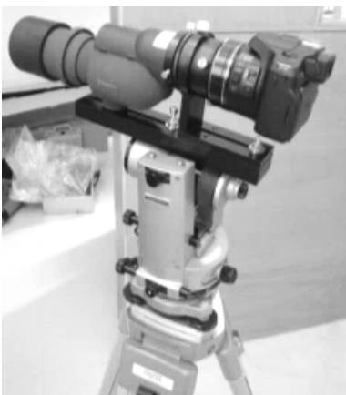
写真-1 カメラ・レンズおよび固定装置
