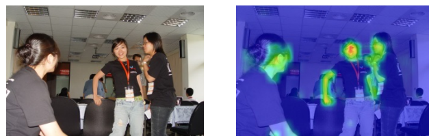
(a) 原图 (b) 肤色显著图 图 3 肤色模型显著图 (a) Image (b) Skin saliency map Fig.3 Skin saliency map
