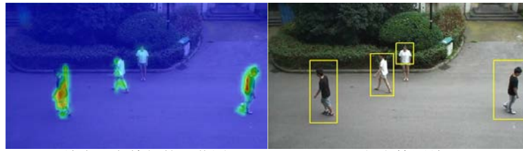
(d) 结合语义特征的显著图 (e) 行人检测结果 (d) The proposed saliency map (e) People detection
